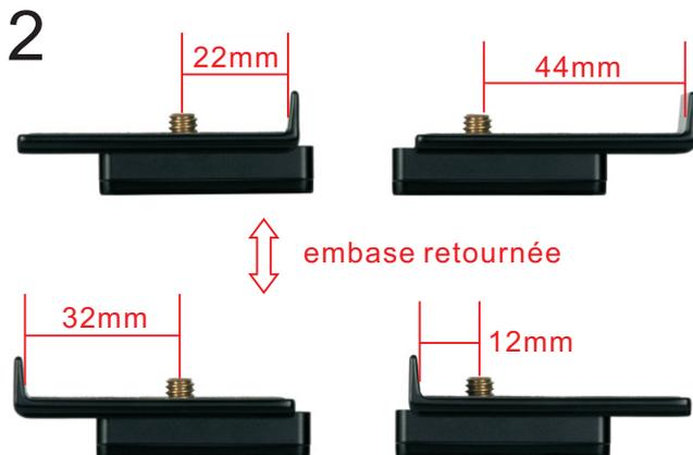
Les images ci-dessus montrent les distances minimales et maximales entre l'attache et le bord de l'appareil photo (distance  $d$ ) que l'embase peut accepter dans chaque sens. Choisir le côté plat de l'appareil photo et mesurer la distance "d".
