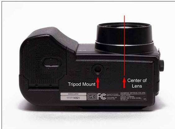
trépied. Si cette axe de fixation est déporté par rapport à l'axe de l'objectif vous aurez besoin d'utiliser le petit T de déport. Si l'écart est de 20mm ou moins vous pouvez utiliser le T20. S'il est compris entre 20 et 30mm vous devez utiliser le T30. L'utilisation de l'adaptateur T permet de positionner l'appareil photo sur la Nodal Ninja de telle façon que vous puissiez faire tourner l'appareil sur son point de Non Parallaxe (ou PNP). (photos d'exemple avec une NN3)
