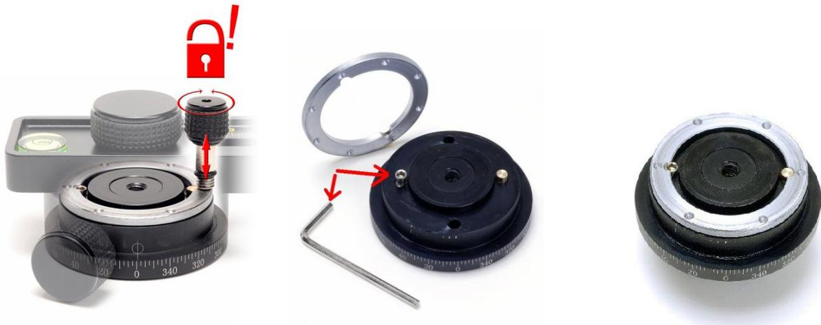
Utiliser la clé hexagonale fournie pour dévisser suffisamment la vis qui retient l'anneau de positionnement. Positionner l'anneau de positionnement souhaité avec le côté désiré sur le dessus. Serrer la vis hexagonale et remonter le tout.
