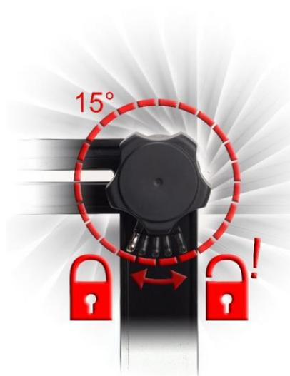
La NN5 (pas la NN5L) dispose d'un dispositif de verrouillage sur le bras supérieur. Ce dernier peut être physiquement verrouillé en place tous les 15° en utilisant la languette. Comme indiqué sur l'image à gauche, lorsque la languette est à droite le bras bouge librement dans n'importe quelle position (comme la NN5L). Par contre lorsque la languette est disposée à gauche (vous devez d'abord dévisser la molette) vous pouvez verrouiller le bras tous les 15° en serrant la molette.
