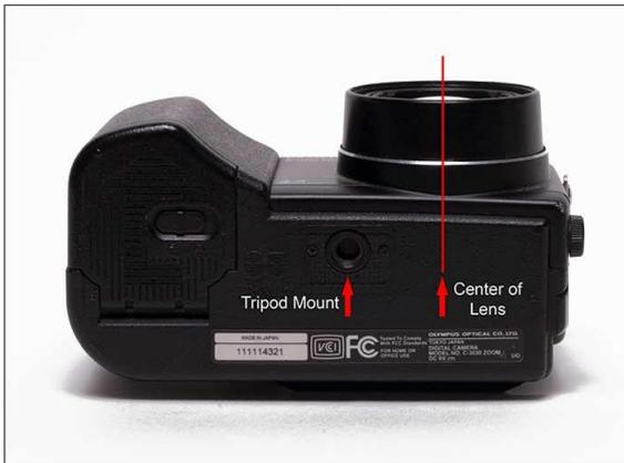
Si votre appareil photo dispose d'une vis de fixation qui est décentrée par rapport à l'axe de l'objectif, vous aurez besoin de l'adaptateur N3T20 ou N3T30. Il vous faut d'abord vérifier s'il est nécessaire. Observez le dessous de votre appareil photo et trouvez l'axe de fixation sur trépied. Si cet axe de fixation est déporté par rapport à l'axe de l'objectif, vous aurez besoin d'utiliser le petit T de déport. Si
