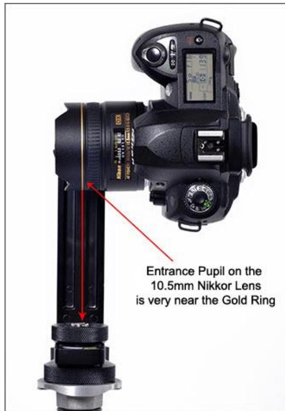
Insérer un bloqueur sur rail comme indiqué et serrer la vis pour verrouiller la position. Cette position supérieure est maintenant réglée et ne changera pas sauf si vous changez d'appareil photo et/ou d'objectif, ou changez de focale.
