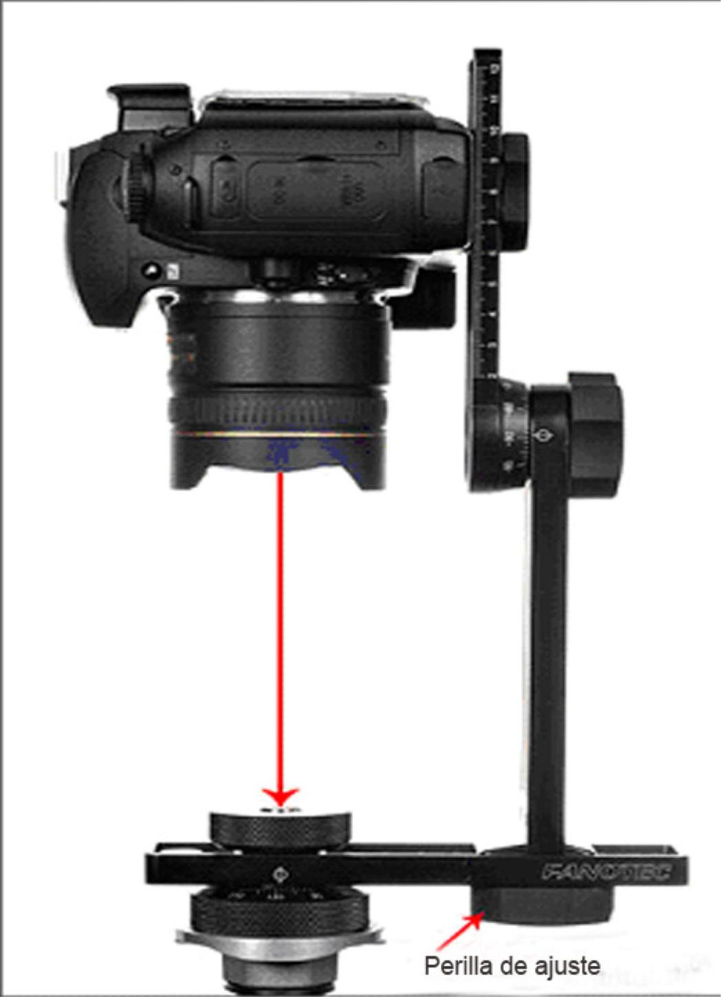
B. Suelte ligeramente la perilla que sujeta el pivote horizontal, rote la cámara hasta que apunte directamente hacia afuera o paralela al suelo. Esta posición es conocida como la posición 0°. Se necesita que la cámara se posicione lo más atrás posible a lo largo de la barra horizontal superior.
