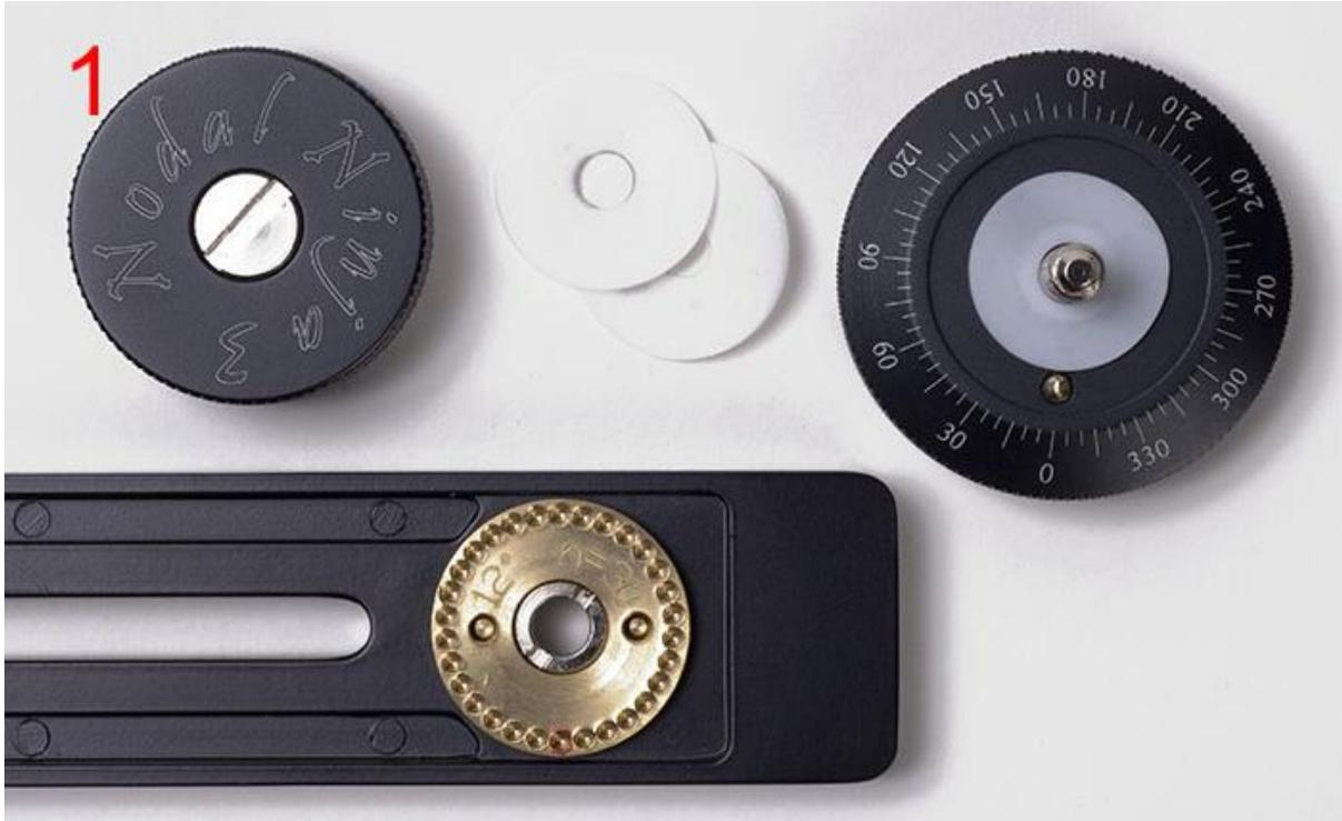
Disassemblare lo snodo panoramico che si trova sul binario inferiore svitando la manopola(1).
